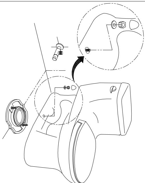
6. Lắp dây cấp với van dừng, cố định bàn cầu và làm kín chân bàn cầu bằng silicone./ *Connect the flexible hose with the stop valve fixed the toilet then the close leg by silicone.*
